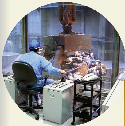
②ごみピット ④ごみクレーン ごみピット容量約11,000m 3 1回のごみクレーンつかみ量約4t A 4 ton crane grabs waste from a 11,000m 3 pit.
