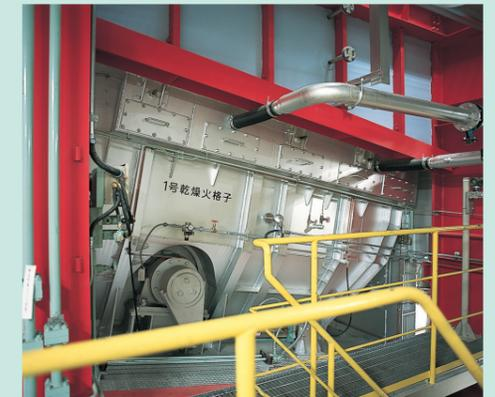
焼却炉 階段状に火格子が設備され、ごみを燃焼させます。
