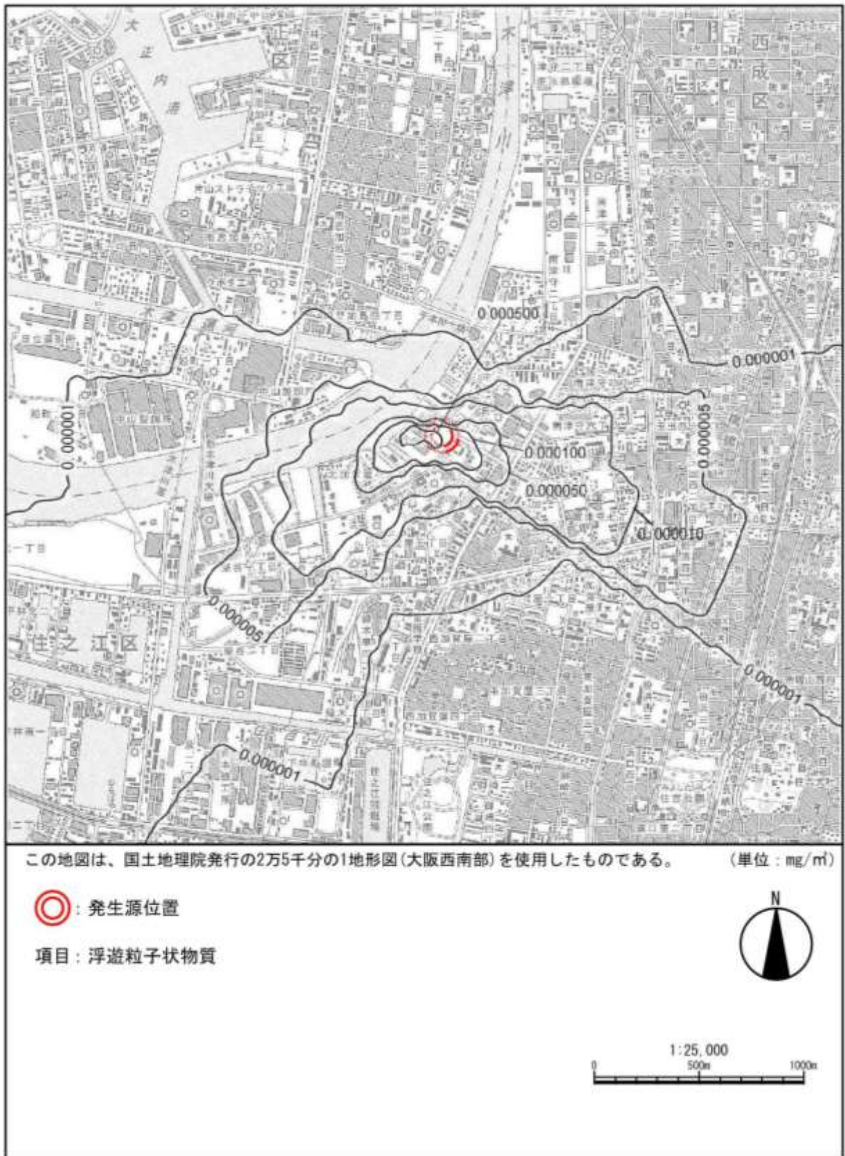
図 5.8.1-3(2) 建設工事における浮遊粒子状物質の年平均寄与濃度予測結果
