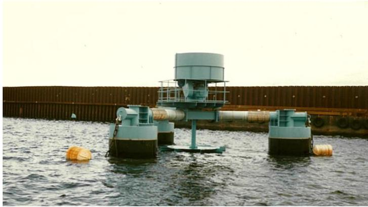
図 1 - 2 フローティングエアレータの外観
