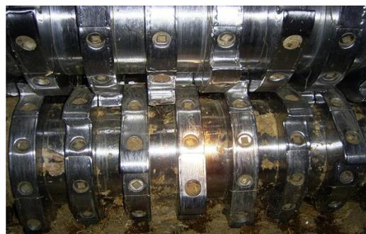
写真－2 せん断破碎機内部
