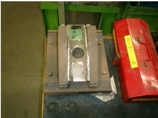
写真-24 粗削り用センターゲージ台
