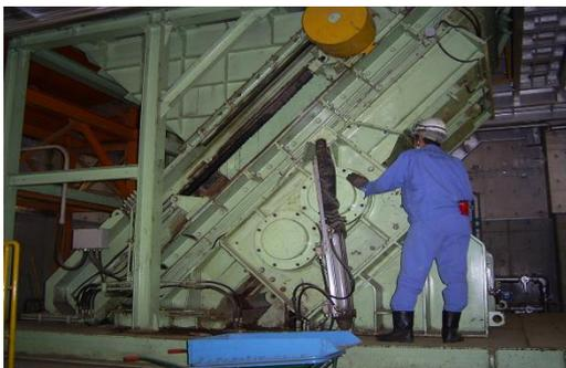
写真－1 せん断破碎機外観
